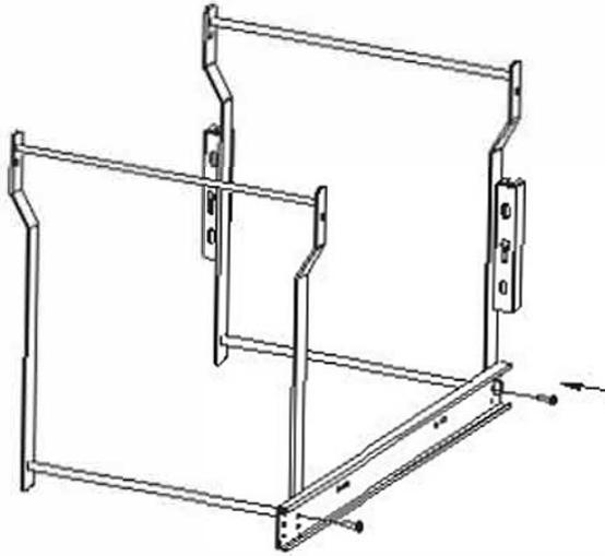
1. Fijar los marcos, con la guía colocando los tornillos en la posición correcta
